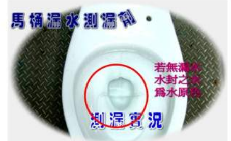
3 觀察水封不漏水為透明 漏水呈現藍色
