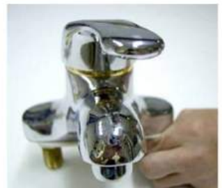
3 觀察水封不漏水為透明 漏水呈現藍色
