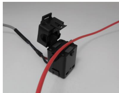
第二步：將比流器扣上量測迴路
