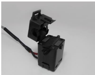
第一步：打開扣式比流器
